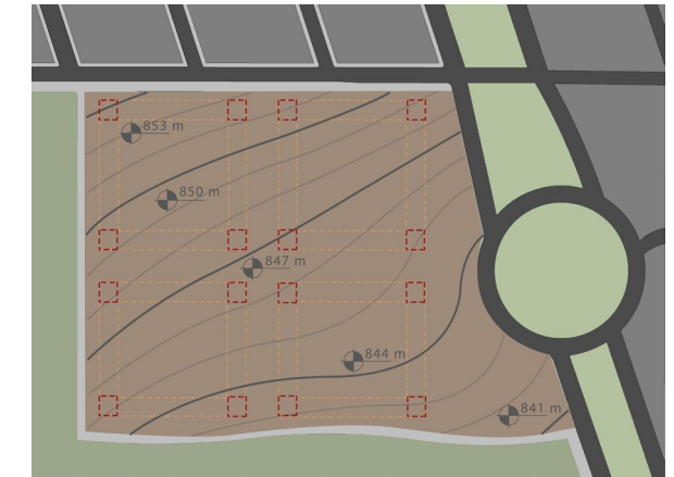
3. Escolha das alturas que receberiam os patamares do projeto a partir da posição dos núcleos de deslocamento vertical.
